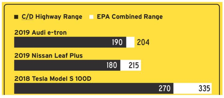
ALL THE EVS WE'VE TESTED, IN ORDER OF THE SMALLEST TO THE LARGEST PERCENTAGE GAP BETWEEN EPA COMBINED RANGE AND OUR REAL-WORLD HIGHWAY TEST.
